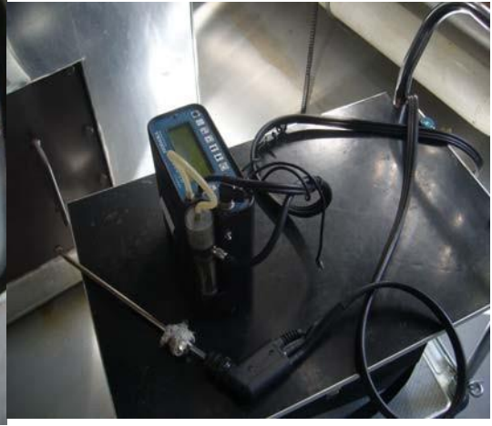
Resim 4.4: Baca gazı emisyon cihazı ve probu
