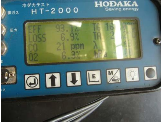
Resim 4.3: Baca gazı emisyon cihazı üstten görünüş
